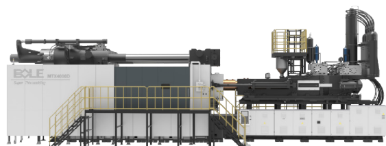
Rys. 23. Maszyna BOLE MTX4000D o sile zwierania 4 000 ton do technologii thixomoulding stopów magnezu oraz odlewy magnezowe wykonane na maszynie o sile zwierania 1600 ton. Maksymalna masa odlewów Mg wynosi 17 kg
