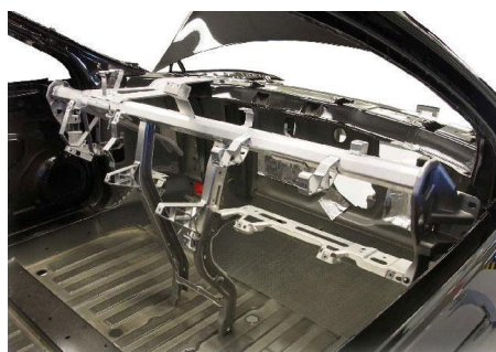
Rys. 22. Tiksotropowy odlew poprzecznej belki samochodowej (CCB) (a) i gotowa część zamontowana w samochodzie [25, 26]
