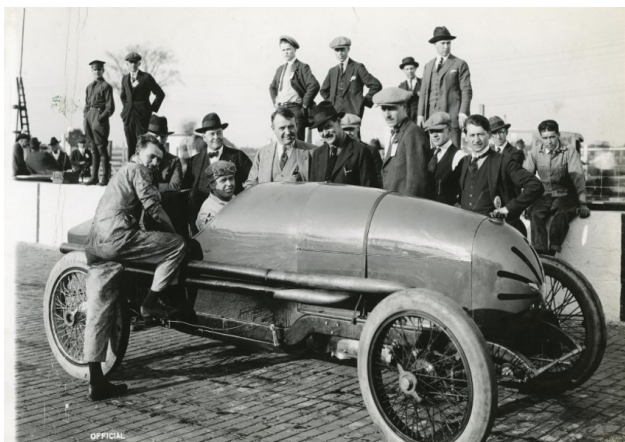
Rys. 17. Tommy Milton, zwycięzca wyścigu Indy 500 za kierownicą samochodu Frontenac, w którego silniku zamontowano magnezowe tłoki Dowmetal. Taki samochód w 1921 roku mógł rozwijać prędkość ponad 140 km/godz. [21]
