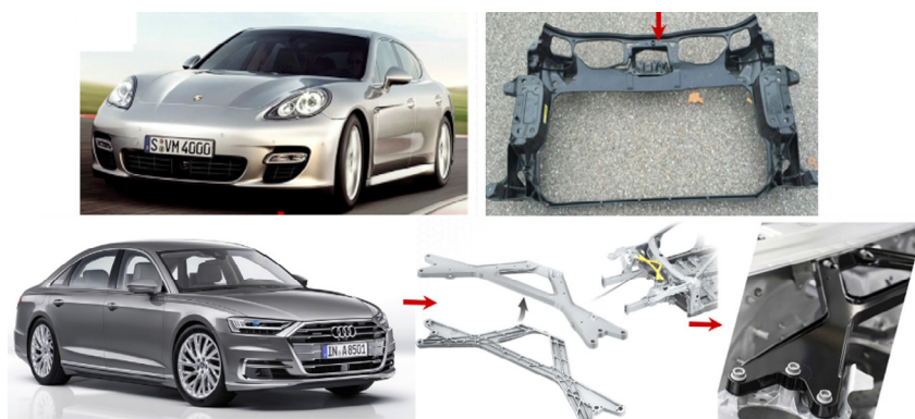
Rys. 19. Odlewy ciśnieniowe ze stopów magnezu znalazły już zastosowanie w samochodach jako części dachu, pokrywy bagażnika, zderzaków i wsporników [17]
