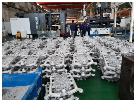
Rys. 23. Maszyna BOLE MTX4000D o sile zwierania 4 000 ton do technologii thixomoulding stopów magnezu oraz odlewy magnezowe wykonane na maszynie o sile zwierania 1600 ton. Maksymalna masa odlewów Mg wynosi 17 kg
