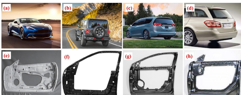
Rys. 18. Zastosowanie stopów magnezu w drzwiach samochodowych: (a) Aston Martin Vanquish S (z wewnętrznymi odlewami drzwiami bocznymi); (b) Jeep Wrangler 2018, wyprodukowany z tylną klapą z Mg; (c) Chrysler Pacifica przedstawiający zespół klapy tylnej z wewnętrznym odlewem Mg; (d) tył modelu T Mercedes-Benz Klasy E z hybrydową tylną klapą ze stopu Mg-Al; (e) wewnętrzna rama drzwi Daimler-Chrysler SL Roadster; (f) koncepcja Forda: wewnętrzne drzwi z odlewanej ciśnieniowo stopu Mg o otwartej architekturze; (g) zintegrowane wewnętrzne drzwi Mg z odlewem Mg (część projektu GMC); (h) wewnętrzne super cienkie drzwi z ultralekkiego stopu Mg [17]
